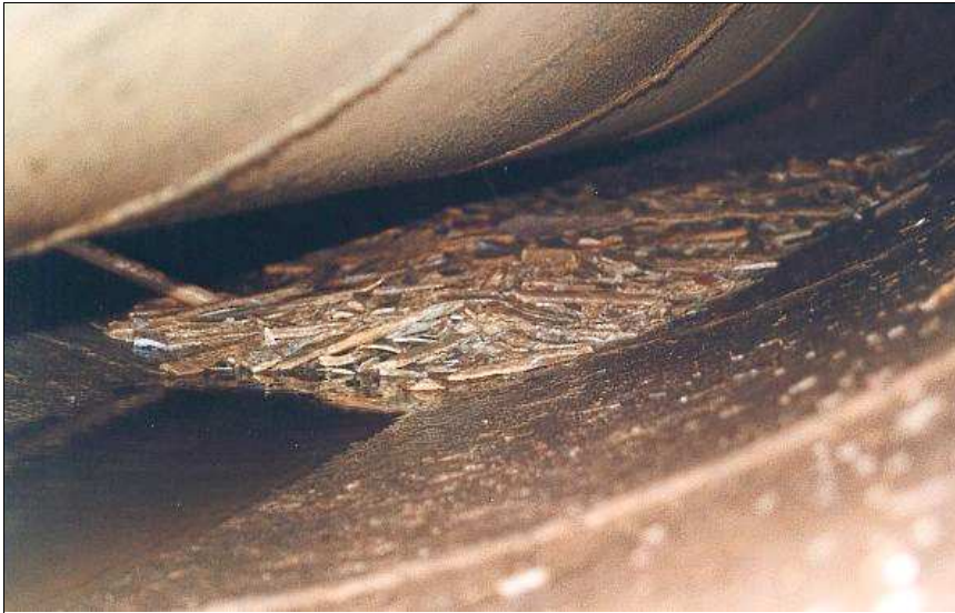
Figura n°5: Acumulación incrustaciones en fondo cue rpo presión caldera.
