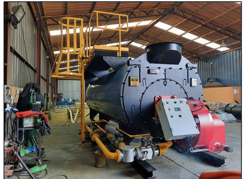
Caldera agua caliente 1100 HP – SQM
