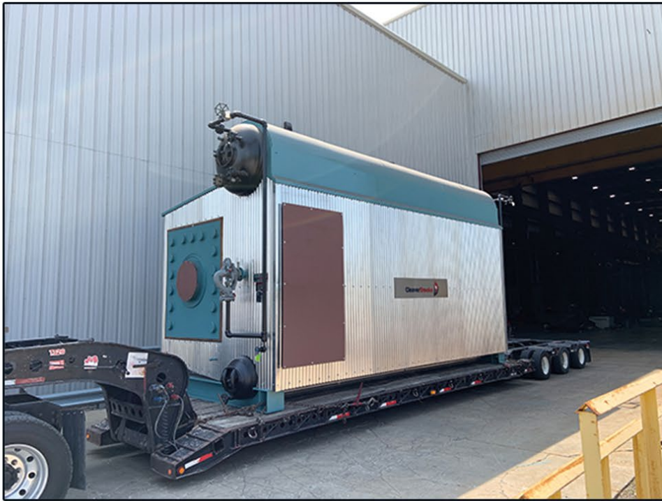
Caldera Generadora de Vapor 40 ton/h Fundición de Cobre
